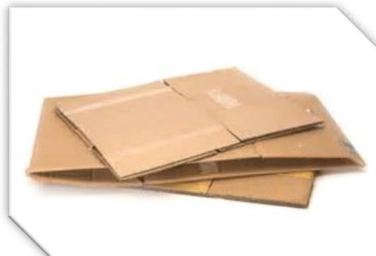
Le carton est une matière constituée de plusieurs couches de papier collé, pouvant être ondulé, formé d'une couche ondulée entre deux couches planes.
