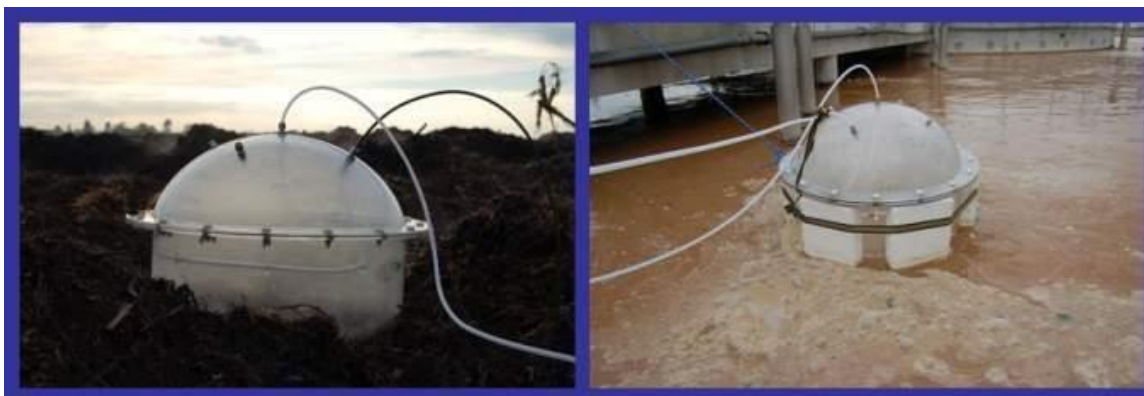
Figure F-1 : Exemple d'une chambre de flux (OdoFlux) sur des surfaces solides et liquides
